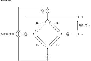
注. 用户请根据需要在③GND插针下方接人调整电阻。 ②NC插针请务必固定在基板上。
